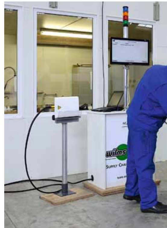
Die in der Ladebrücke integrierten RFID-Antennen erfassen die Ware
